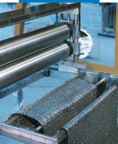
Impregnación con máquina de MapeWrap C
